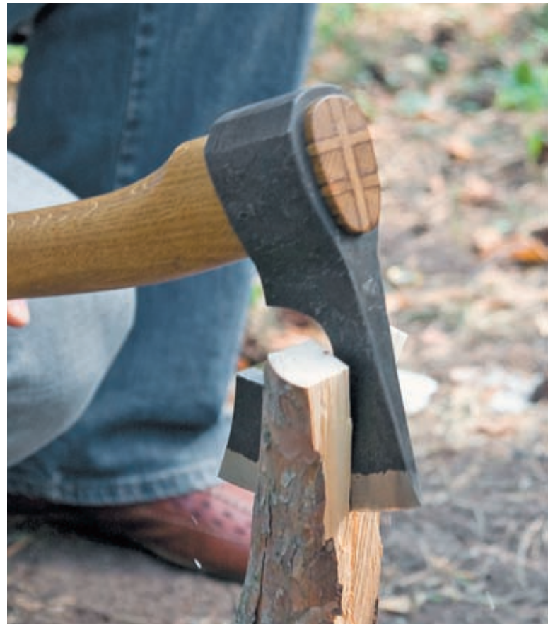
Топор «Плотник». Топор насажен на топорщике при помощи пяти дубовых клиньев с проклейкой водостойким составом
