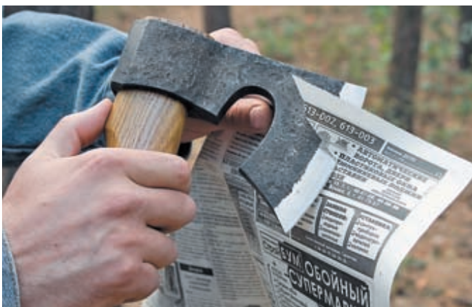
После месяца интенсивного использования топор «Плотник» также остер, как и в начале испытаний
