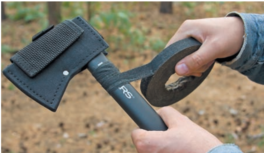
Средство против вибрации рукояти топора Fiskars – матерчатая чёрная изолента
